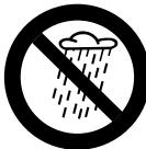
Niet bij regen en ook niet in een natte of zeer vochtige omgeving werken – de elektromotor is niet waterdicht – **kans op elektrische schokken en kortsluiting!**
