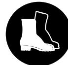
Porter des **chaussures de sécurité** – avec garniture anticoupure, semelle antidérapante et calotte en acier.
