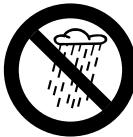
Nicht bei Regen und auch nicht in nasser oder sehr feuchter Umgebung arbeiten – der Elektromotor ist nicht wassergeschützt – **Stromschlag- und Kurzschlussgefahr!**
